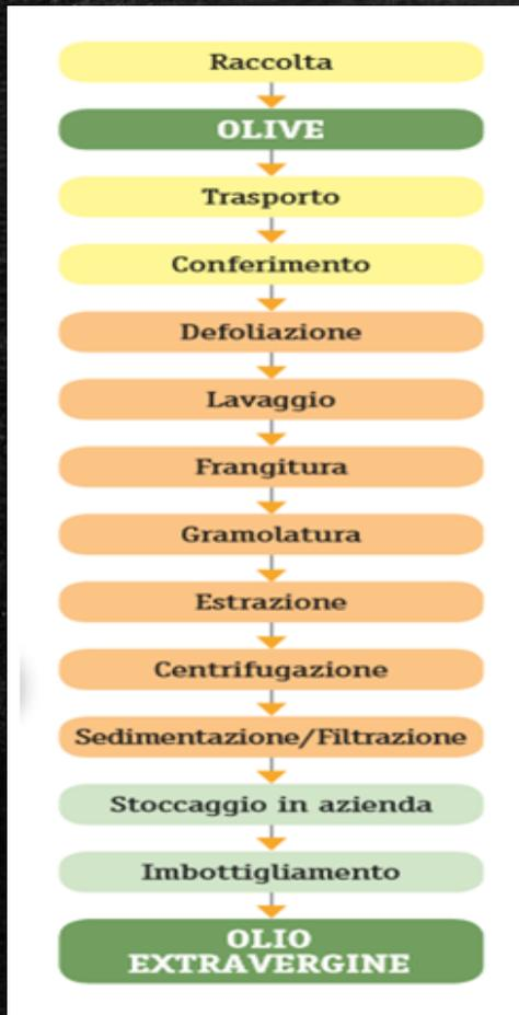
Il processo di estrazione dell'olio di oliva dalle drupe dell'olivo avviene presso l'**oleificio** (o **frantoio**) e consiste in diverse **fasi**, molto importanti per determinare la qualità finale dell'olio ottenuto
