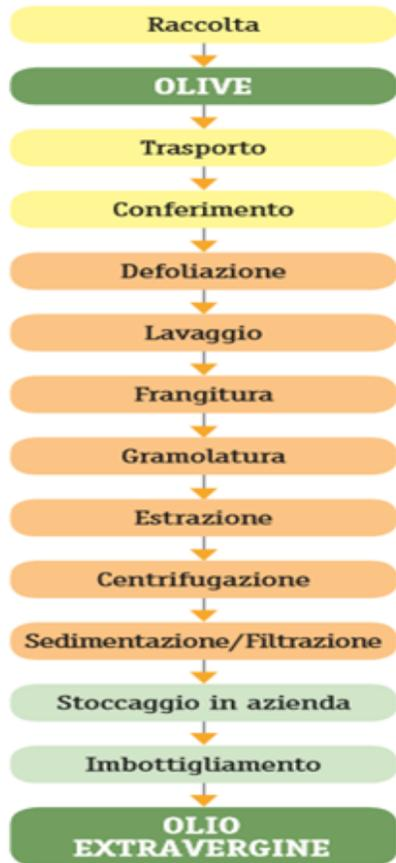
La separazione dell'acqua e delle componenti solide nella pasta di olive può essere eseguita mediante diversi sistemi di estrazione
