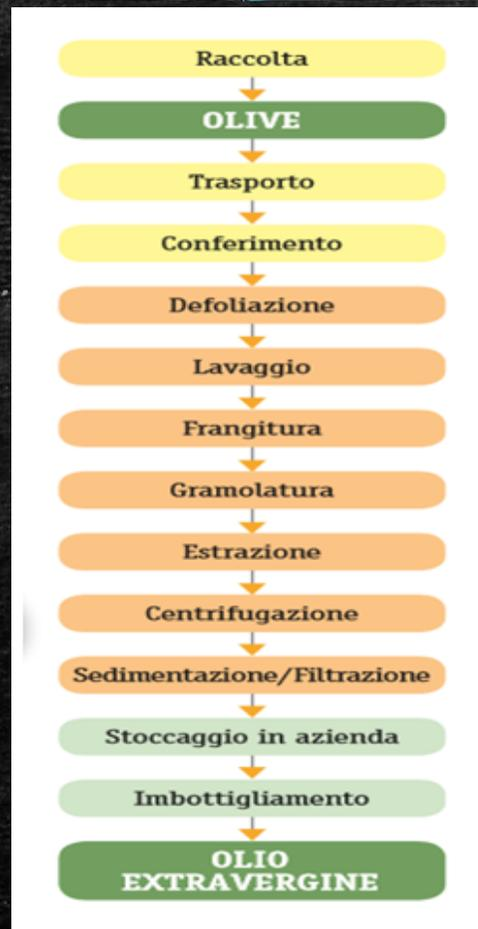
Avviene in **centrifughe** in grado di **separare** i due costituenti del mosto oleoso: un liquido pesante (l'acqua di vegetazione) e un liquido leggero (l'olio)
