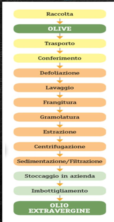
L'olio ottenuto dalla centrifugazione viene travasato in vasi d'acciaio saturati con una un'atmosfera di azoto utile a prevenire eventuali ossidazioni che potrebbero causare fenomeni di irrancidimento
